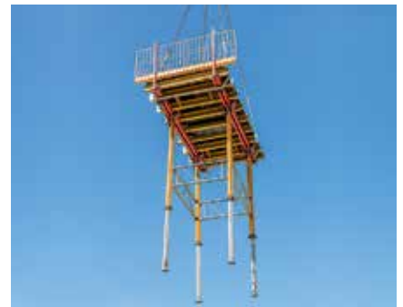
Pour les tables VARIODECK, les étais MULTIPROP sont fixés en position verticale à l'aide des cadres MRK.
