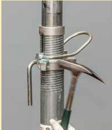
L'écrou de réglage a une face de taille généreuse qui permet la frappe avec un marteau et détermine la direction de l'impact.
